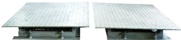
Hydraulisch bewegte Prüfplatten
